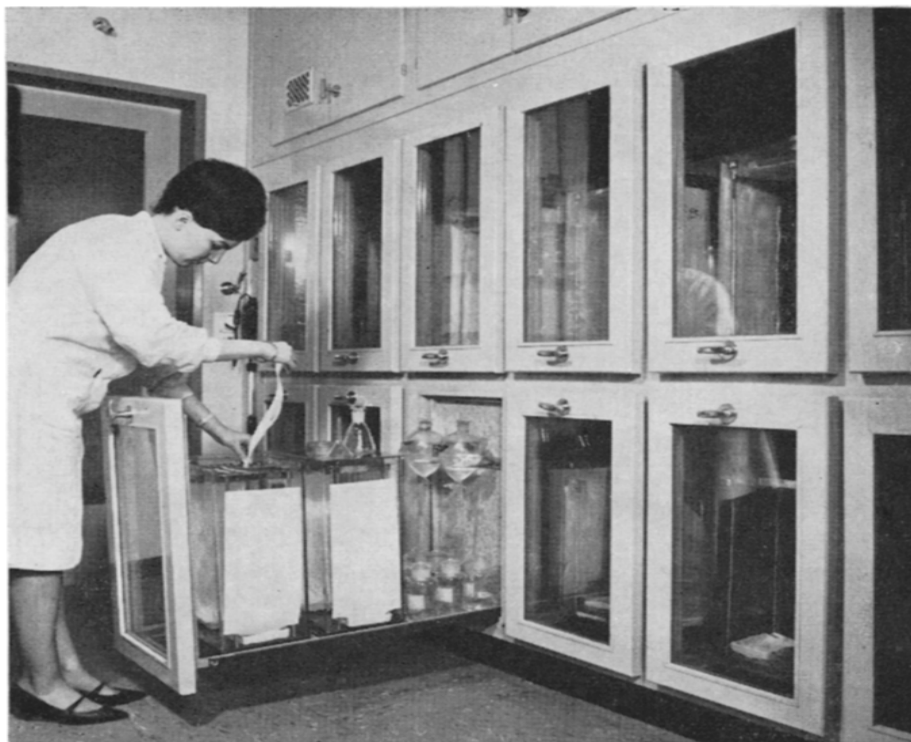
Abb. 5. Raum C: thermostatierte Kammer mit Schubladen, die gegen hinten abgeschlossen sind, zur Chromatographie bei erhöhter Temperatur; s. Fig. 1 und 2.
