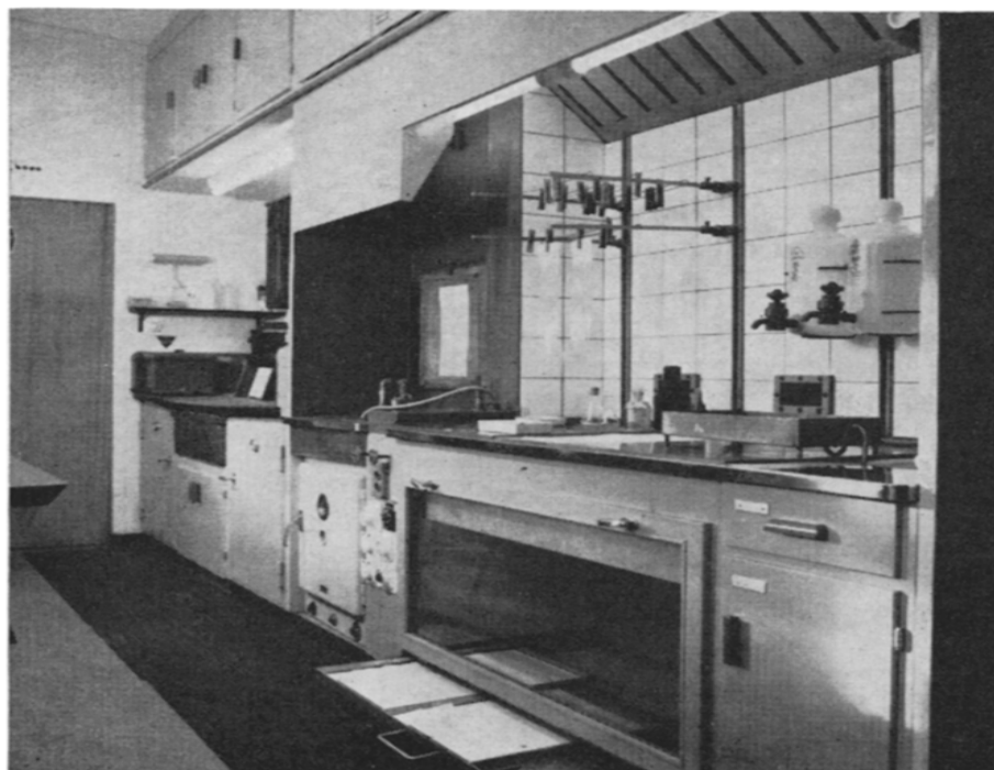
Abb. 10. Raum E: hinten links Eingang zu Dunkelkammer F, anschliessend Wasch- und Spültrog (10), dann Trockenschrank (31) mit Spezialabzug für Chromatogramme mit stark reizenden Indikatoren (s. Fig. 3b), darüber Sprühkasten (28) mit Drahtnetz, Luftvorhang und Spezialabzug (s. Fig. 3b); gegen vorne, unten I.R.-Trockenraum (32) für spezielle Chromatogramm-Trocknung, darüber Abzug für Reagenzien-Applikation etc. (29); s. Fig. 3a und 1.
