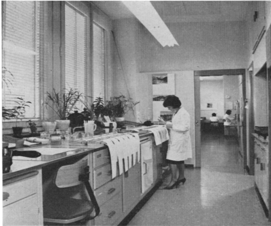
Abb. 1. Raum B (gegen Raum E): Auftropftisch (7), links eine Sitznische (8), daneben (14) und oben rechts (22) Papierlager; Mitte rechts Nische für Papierelektrophorese (25); s. Fig. 1.
