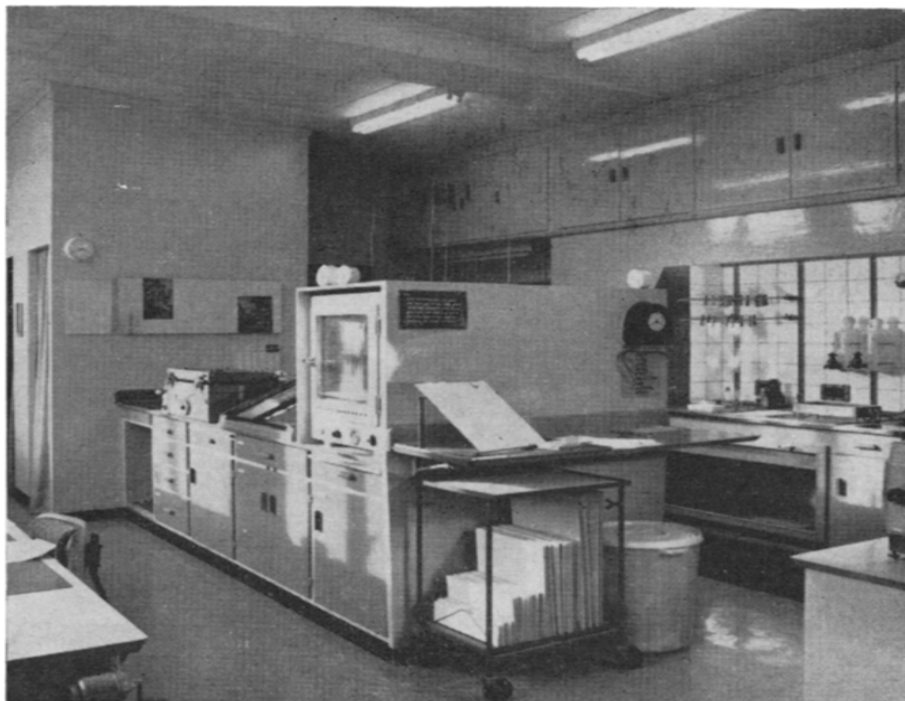
Abb. 9. Raum E: Auswertung; im Hintergrund Dunkelkammern G und F, auf dem Mittelkorpus von hinten nach vorne Lichtpauserät (34), Pantograph (33), Trockenschränke mit Glastüren und Luftabzug (31), Arbeitstisch für Tauch-Indikatoren (30), rechte Wand mit Abzug für Indikatorenapplikation (29, 30); s. Fig. 1.
